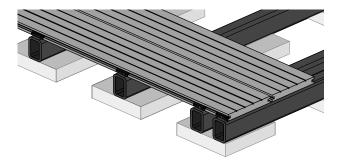
Grundsätzlich muss jeder Stoß/Versatz so angeordnet werden, dass die jeweilige Diele am Versatz **an einer separaten Unterkonstruktion und einem separaten Clip** im Stoßbereich befestigt werden kann. So wird eine gleichmäßige Kraftübertragung möglich.
