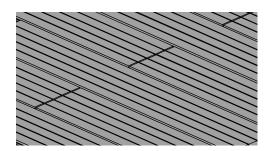
Um Verwerfungen und Bruchgefahr zu vermeiden, achten Sie bei der Verlegung darauf, dass die Dielen am Ende nirgends **mehr als 2 cm** über den Unterbau frei überstehen. Dies gilt auch für die Montage auf der HQ-Aluminium Unterkonstruktion.
