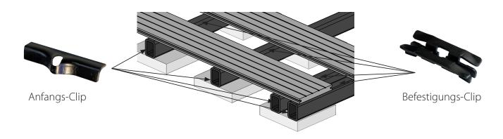
Die letzte Diele befestigen Sie wieder mit dem Anfangs-/Endclip. Die Terrassendielen müssen grundsätzlich an jedem Auflagepunkt der Unterkonstruktion mittels des Clips auf beiden Seiten befestigt werden. Dabei ist darauf zu achten, dass die Terrassendielen vollflächig auf der Unterkonstruktion aufliegen.
